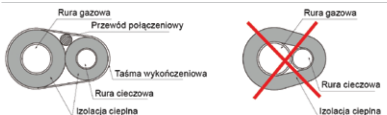
Rys. 6. Prawidłowa i błędna izolacja rur chłodniczych
