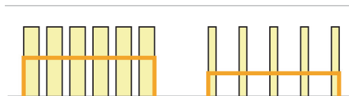
Rys. 5. Sterowanie PWM dla prądu DC
